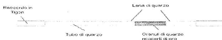
Fig.1 SCHEMA TRAPPOLA DI CAMPIONAMENTO
